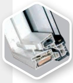
Las ventanas más fáciles de mantener son las ventanas en PVC y aluminio. Los perfiles multicámara de PVC reforzados con molduras de acero no absorben la humedad, son duraderos y resistentes a la corrosión. Estas ventanas están diseñadas especialmente para las estancias y zonas de humedad prolongada (baños, lavanderías).
