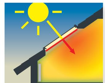
La radiación que pasa a través del cristal incide sobre la cortina, elevando la temperatura interior.
