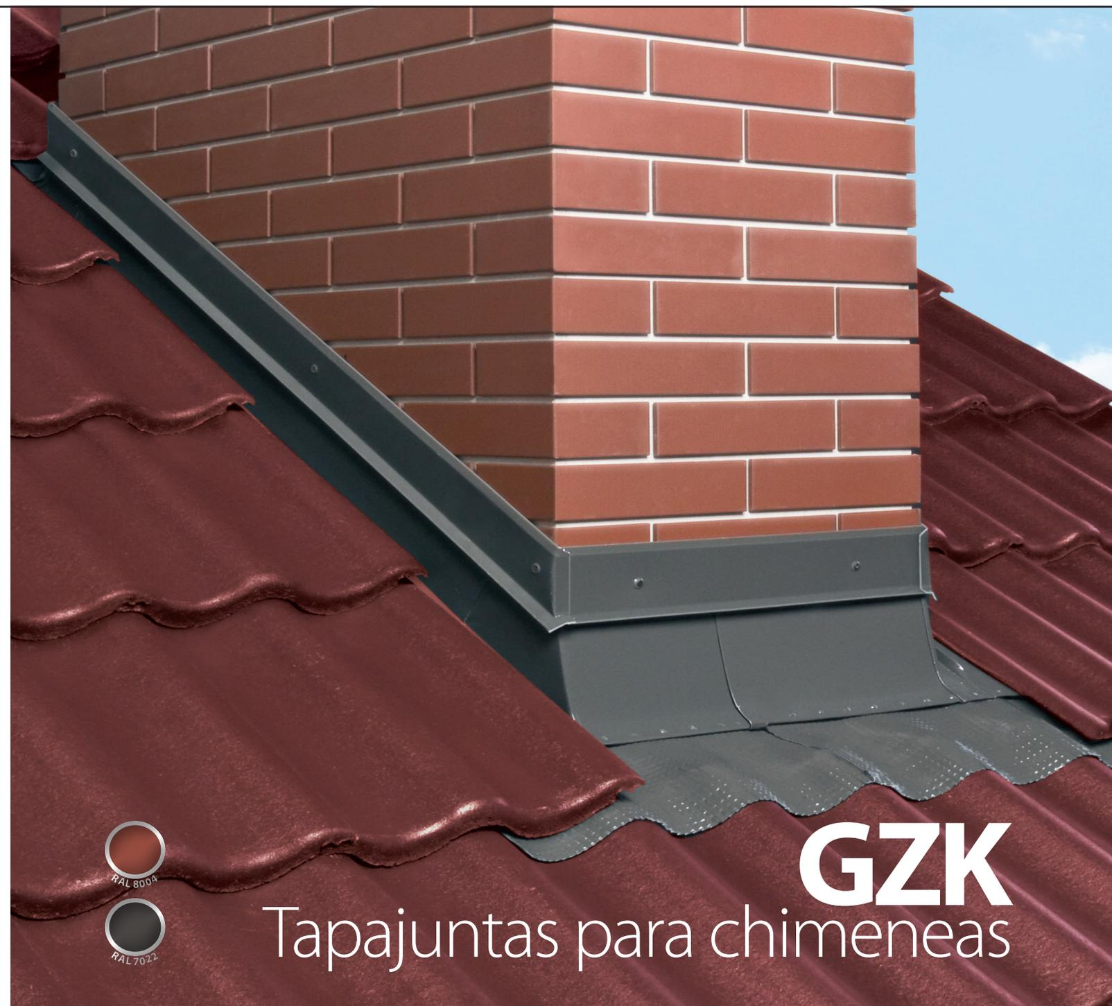
El tapajuntas para chimeneas **GZK** es el sistema de tapajuntas que se instala de una manera fácil y estanca alrededor de la chimenea. Se pueden instalar en cubiertas con inclinación entre 15 y 70 grados. El babero flexible en la parte inferior permite instalar el tapajuntas en todas las cubiertas. Los tapajuntas están fabricados en chapa de aluminio protegida con el poliéster modificado de alta resistencia a los agentes atmosféricos.
