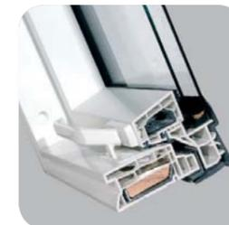
Las ventanas más fáciles de mantener son las ventanas en PVC y aluminio. Los perfiles multicámara de PVC reforzados con molduras de acero no absorben la humedad, son duraderos y resistentes a la corrosión. Estas ventanas están diseñadas especialmente para las estancias y zonas de humedad prolongada (baños, lavanderías).
