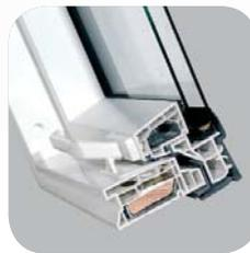
Las ventanas también pueden estar construidas en aluminio/PVC. Fabricada con perfiles extrusionados en PVC y aluminio, multicámara, y reforzada con molduras de acero, que aseguran la estabilidad de su estructura y previenen deformaciones. El material no absorbe la humedad, la ventana es duradera y resistente a la corrosión. La ventana también está disponible en color roble oro o pino. Los perfiles PVC FAKRO son de la clase más alta A, fabricadas según la norma EN 12608.
