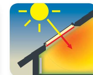
A radiação que passa através do vidro incide sobre a cortina, elevando a temperatura interior.
