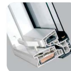
As janelas mais fáceis de preservar são as janelas em PVC e alumínio. Os perfis multicâmara de PVC reforçados com molduras de aço não absorvem a humidade, são duradouros e resistentes à corrosão. Essas janelas são idealizadas especialmente para as divisões e zonas de humidade prolongada (casas de banho, lavandarias).
