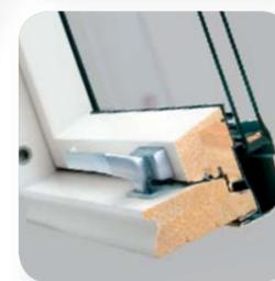
As janelas de madeira revestida de poliuretano são destinadas a divisões com alto nível de humidade (cozinhas, casas de banho). São tratadas a vácuo e revestidas de três camadas de espuma de poliuretano, que cria na superfície do aro uma camada branca, duradoura e perfeitamente lisa.
