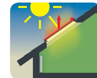
Os acessórios exteriores são a melhor proteção contra as altas temperaturas. Absorvem os raios UVA antes que estes cheguem ao vidro, evitando assim, o excesso de calor nos dias de verão
